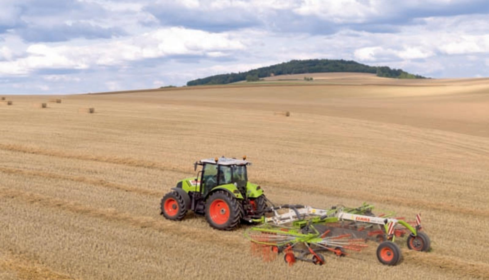
le condizioni della raccolta mediante le battute di fine corsa registrabili idraulicamente in continuo. A fine campo il telo formandana si ripiega automaticamente verso l'alto, lasciando ampio spazio per andane alte. Dei pesi, montati di serie sulle ruote del telaio principale, assicurano una presa sicura su terreni in pendenza o durante il sollevamento delle singole giranti. Ogni girante è protetta contro i sovraccarichi.
