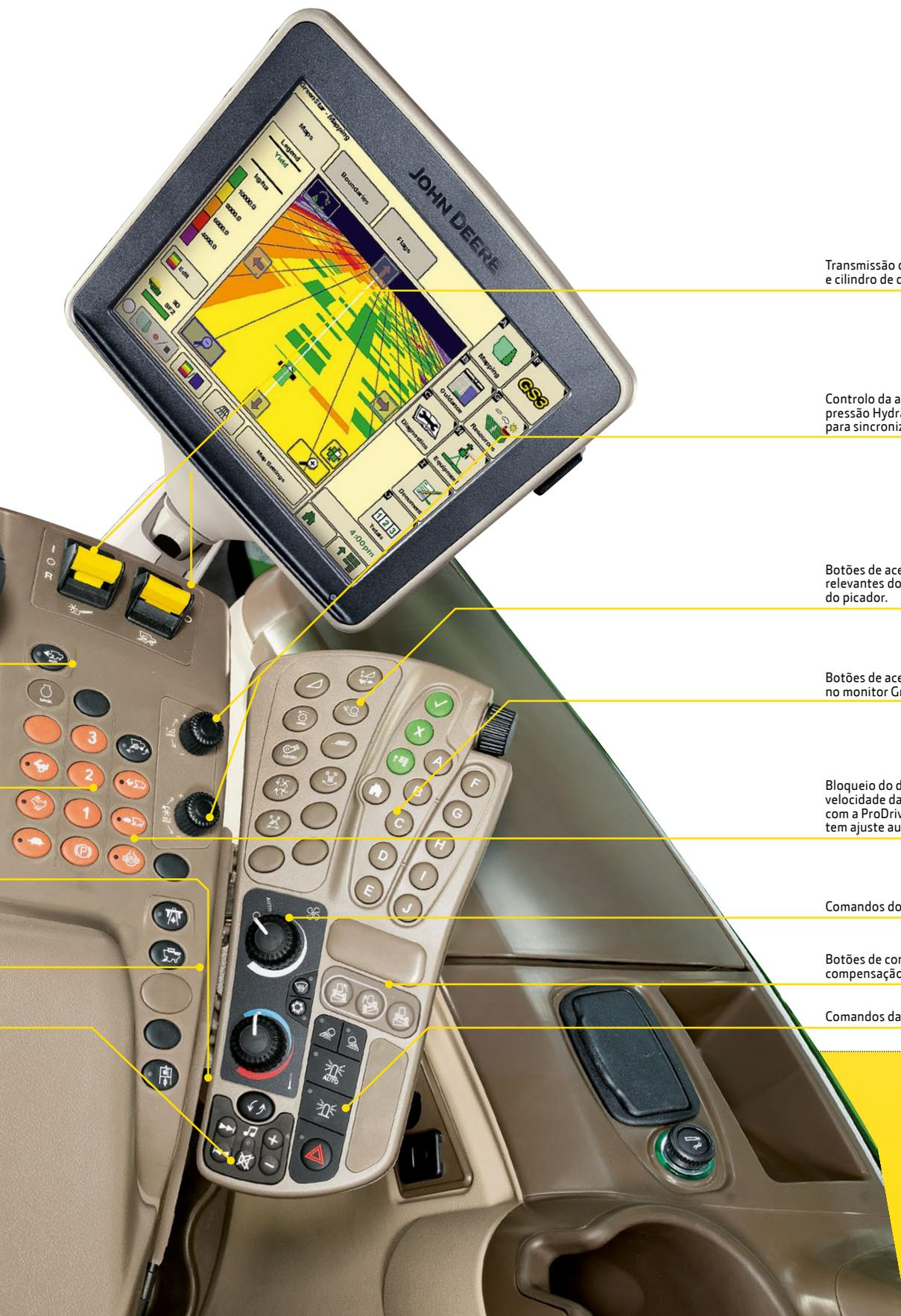
Transmissão da cabeça de corte incluindo inversor e cilindro de debulha
