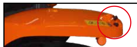
Externe bedieningsknoppen voor driepuntshef (aan beide kanten)
