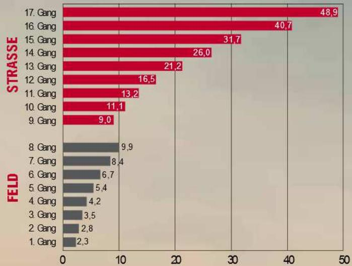
Höchstgeschwindigkeit des 4-stufigen 17x16-Vollastschaltgetriebes
