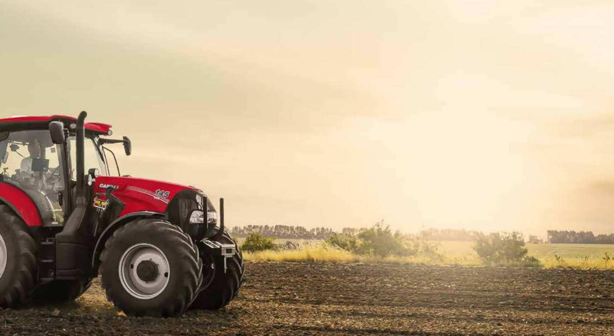
Für die Case IH Maxxum-Baureihe ist Kompatibilität kein Problem. Unser CVX-Getriebe und die FPT-Motoren wurden von Anfang an in enger Zusammenarbeit entwickelt, als diese Traktoren erst auf dem Zeichenbrett existierten. Dank des automatischen Produktivitäts-Managements (APM) zur Abstimmung von Motordrehzahl und Getriebeübersetzung arbeiten sie harmonisch zusammen und
