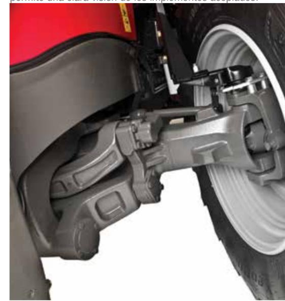
El eje delantero con suspensión 'QuadLink' de MF supone una mejora adicional del confort y el control. Presenta un diseño compacto y sencillo que mantiene automáticamente una altura de suspensión constante, con independencia de la carga sobre el eje.
