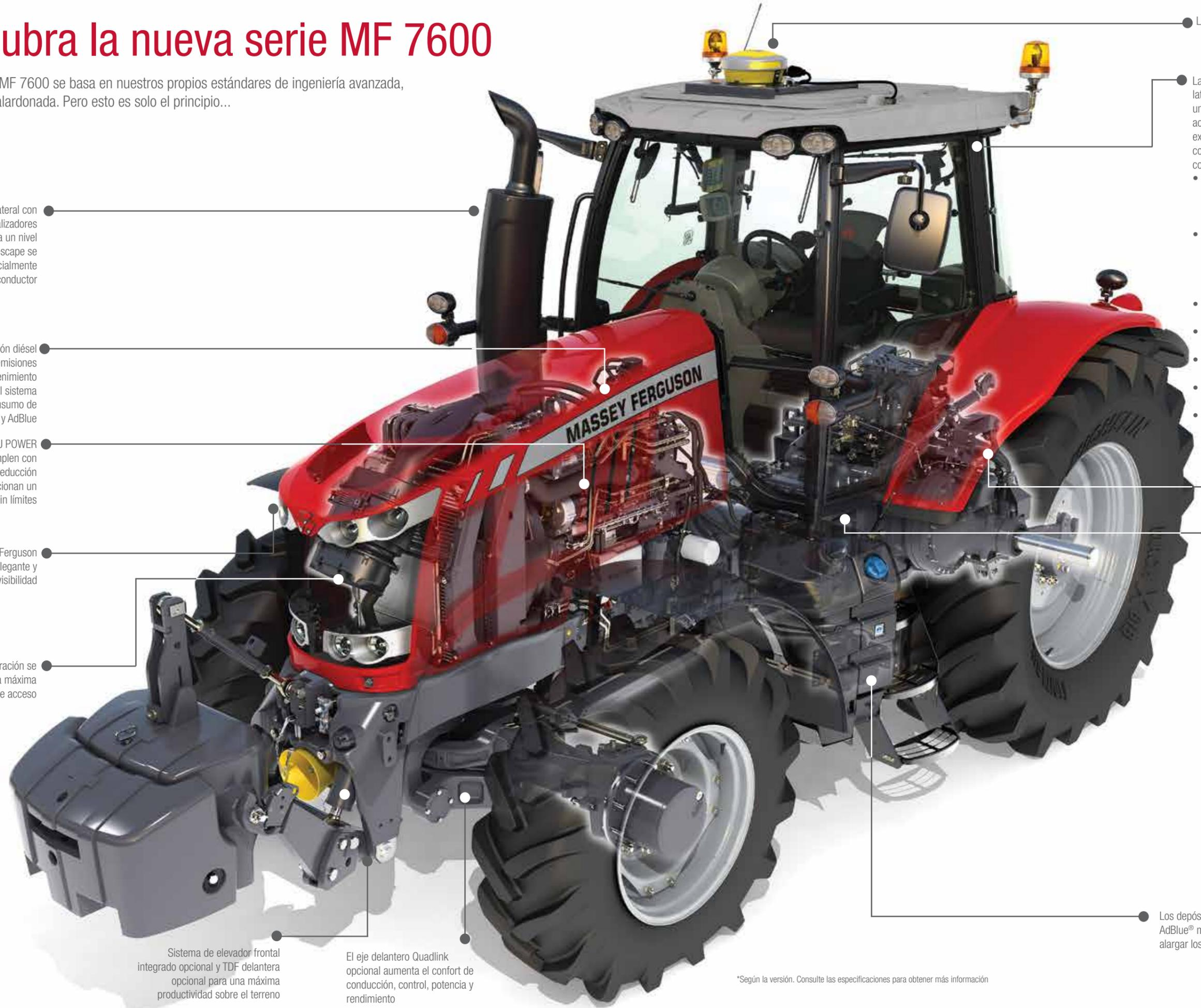
El nuevo y único escape lateral con catalizadores integrados y catalizadores de desplazamiento proporciona un nivel de emisiones aún más bajo. El escape se ha diseñado y colocado especialmente para que no impida la visión del conductor
