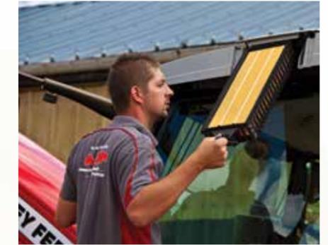
El filtro de aire de la cabina se puede retirar fácilmente para su limpieza
