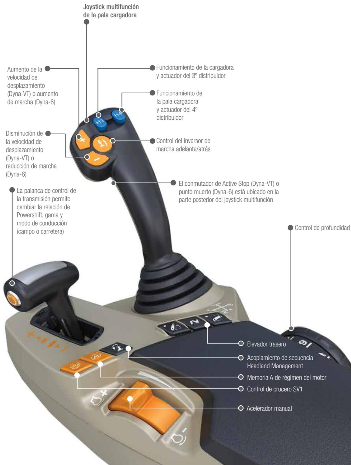
El Command Control Armrest se puede especificar con un joystick multifunción. Por ejemplo, cuando no se necesite usar con una pala cargadora, con Datatronic 4 opcional, los botones se pueden programar para que incluyan otras opciones, incluido:
