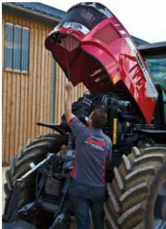
Resulta muy fácil de acceder, limpiar y realizar el mantenimiento del paquete de refrigeración, que está muy bien proporcionado. El 90% del polvo se elimina de manera natural gracias a la succión del ventilador de refrigeración. También resulta muy fácil acceder y limpiar el depurador de aire del motor.
