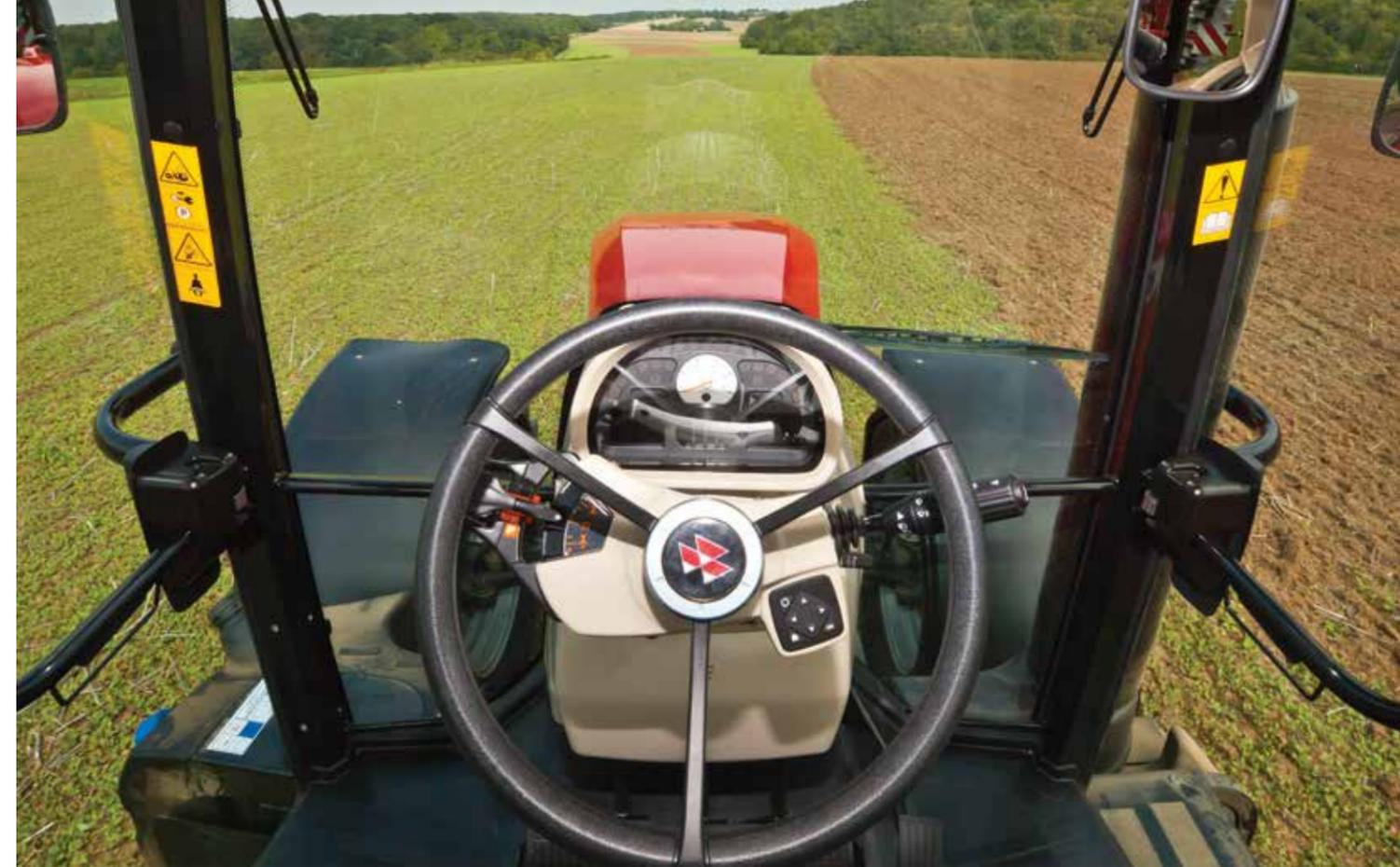
Una cabina con una forma rediseñada ofrece una excelente visibilidad en todos los ángulos. La combinación del posicionamiento de escape, el diseño esbelto del capó y las amplias zonas de cristal aseguran una visibilidad de 360°. La buena visibilidad desde la ventanilla trasera mejora la seguridad y permite una clara visión de los implementos acoplados.
