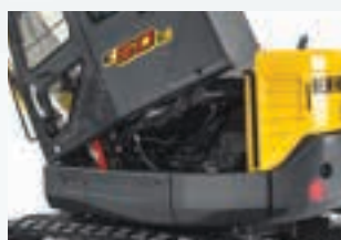
La cabine inclinable vers l'avant facilite l'accès pour l'entretien.
