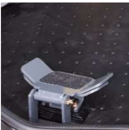
Pedali brandeggio con protezione anti azionamento involontario.
