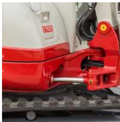
Brandeggio idraulico del braccio su 133°.
