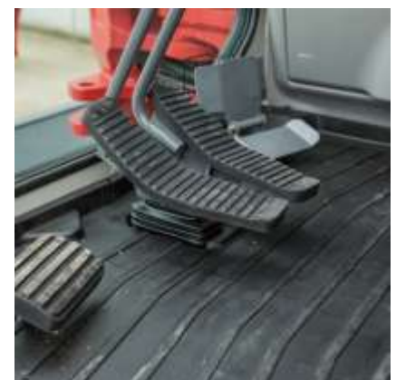
Controllo avanzamento mediante due leve accoppiate a due pedali con rivestimento antiscivolo.
