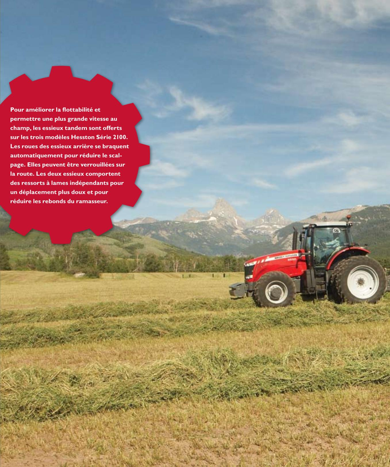
Pour améliorer la flottabilité et permettre une plus grande vitesse au champ, les essieux tandem sont offerts sur les trois modèles Hesston Série 2100. Les roues des essieux arrière se braquent automatiquement pour réduire le scalpage. Elles peuvent être verrouillées sur la route. Les deux essieux comportent des ressorts à lames indépendants pour un déplacement plus doux et pour réduire les rebonds du ramasseur.
