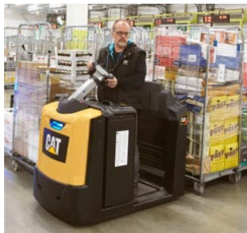
Basandosi sulla tecnologia del Sistema di Guida Sensibile (Responsive Drive System - RDS) introdotta sui recenti carrelli elevatori elettrici Cat, questi carrelli commissionatori reagiscono rapidamente a seconda di come l'operatore usa lo sterzo e alla velocità di traslazione.
