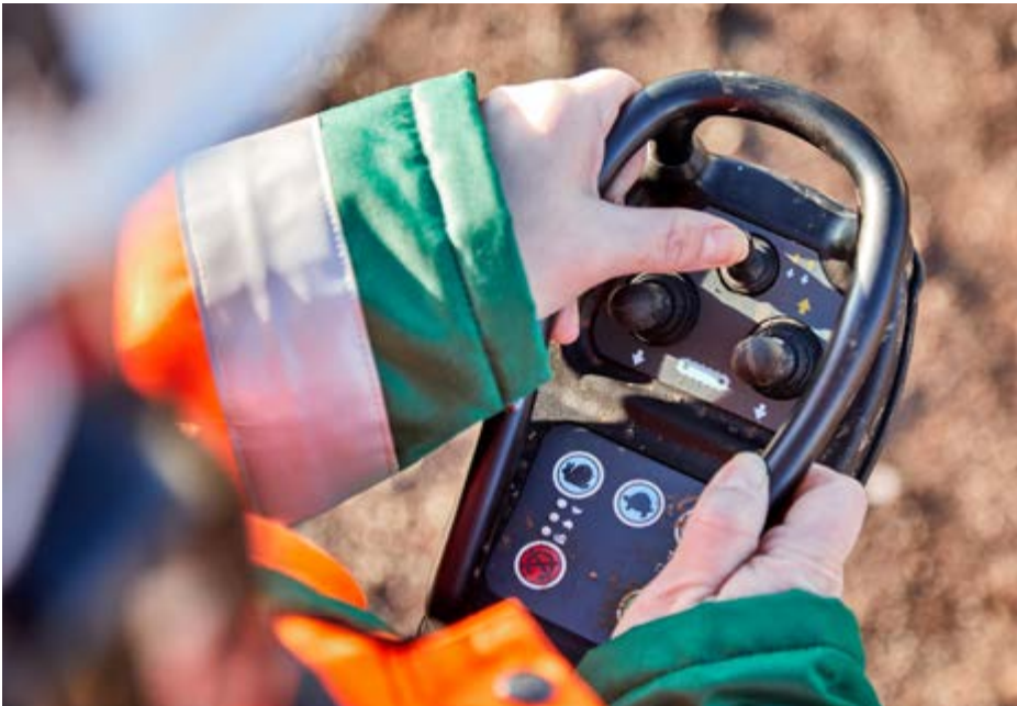
Control remoto para las orugas como equipamiento de serie.
