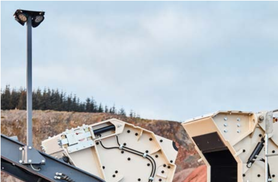
Éclairage de travail de série pour une meilleure ergonomie et une sécurité renforcée.
