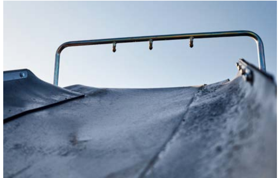
Système de pulvérisation d'eau pour une suppression efficace des poussières, avec pompe.
