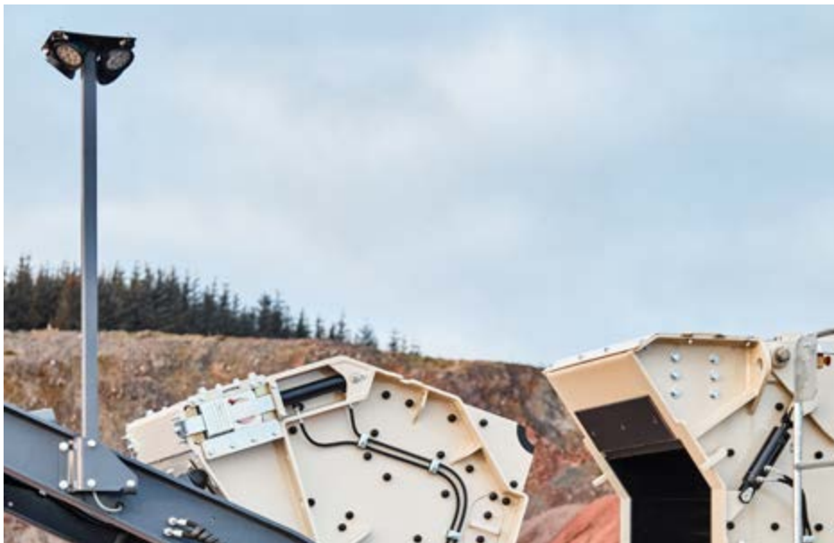
Рабочее освещение в стандартной комплектации для улучшения эргономики и безопасности.
