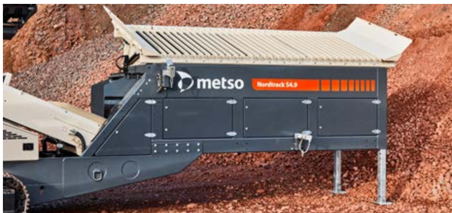
Прочная колосниковая решетка с дистанционным управлением наклона. Предлагается также виброрешетка
