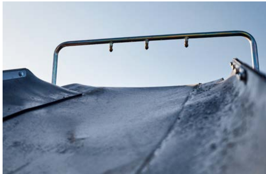
Оснащенная насосом эффективная система пылеподавления путем распыления воды.
