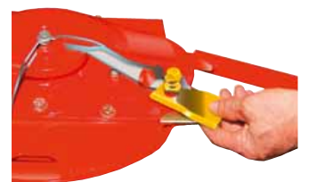
Federbügel mit Klingenschlüssel nach unten drücken – Klinge tauschen
