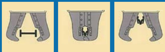
Prise de la structure IPN Compression de l'IPN Coupe de l'IPN par les lames
