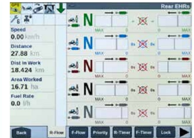
Vue d'ensemble des paramètres de débit et de temporisation sur le moniteur AFS Pro 700™.
