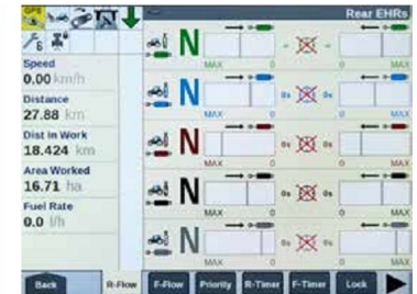
Natężenie przepływu i ustawienia regulatorów czasowych widoczne w jednym miejscu na monitorze AFS Pro 700™.
