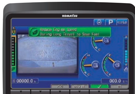
Sistema avanzato di monitoraggio con la vista della telecamera posteriore nella schermata principale. Indicatore Eco, guida Eco ed indicatore livello carburante per diminuire considerevolmente il consumo di carburante.
