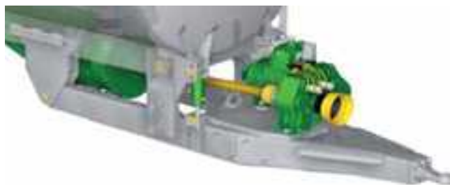
Mechanische aandrijving door aftakas van de pompen
