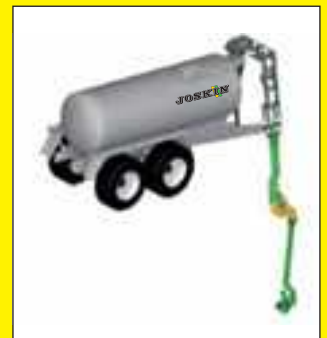
Armvooraan met een dompelturbo
