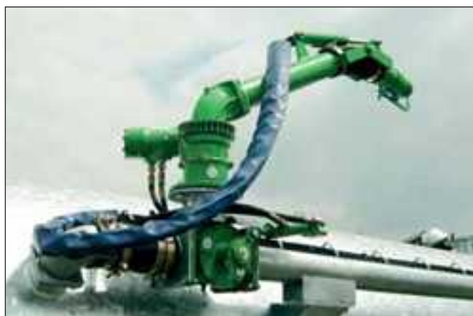
Volumetrisch mengen met retourleiding in de tank via hydraulische drierwegkraan
