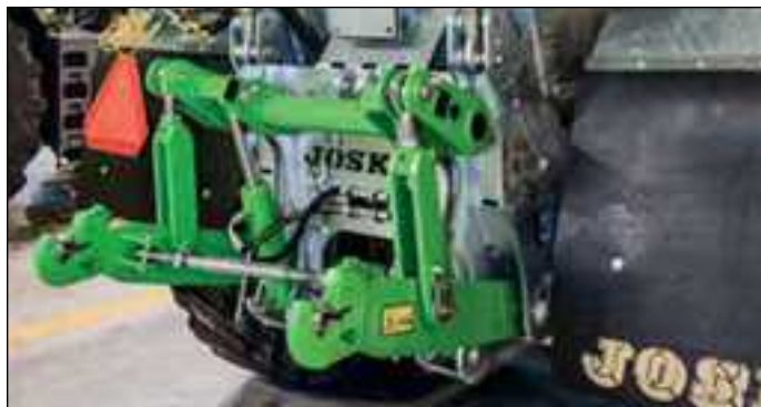
Geïntegreerde L hefinrichting in de tank op VOLUMETRA
