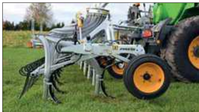
TERRAFLEX/2 uitgerust met een nivelleereg
