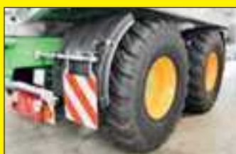
Spatbord op Vacu-CARGO met onafhankelijke spatlappen
