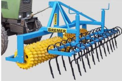
**Frontpolygonwalzen** mit bruchsicheren Sphärogußringen in 450 mm und 550 mm Durchmesser können Sie bis 9 Meter Arbeitsbreite im Frontanbau, bis 9 Meter Arbeitsbreite im Heckanbau und bis 18 Meter Arbeitsbreite auf Fahrwerk beziehen. Für leichte Böden im Frontanbau oder als Nachläufer hinter *Grubber* oder *Scheibeneggen* sind die 550 mm Ringe erforderlich. Bei mittelschwere bis schwerste Böden sind die 450 mm **Polygonringe** empfehlenswert.
