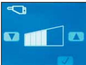
Hydraulikkavirtauksen säästönäytön hienosäätö B-työtavalla (iskuvasaran käyttö).
