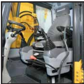
Istuimen säätöalue: 340 mm
