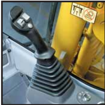
Joystick-hallintavivut, joissa proportionaaliset hallintapainikkeet työlaitteita varten
