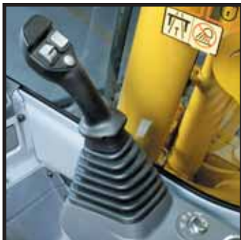
Gravespaker med brytere for proporsjonalstyring av redskaper
