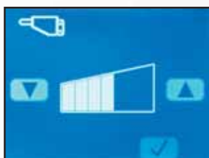
Ekran precyzyjnej regulacji natężenia przepływu oleju w trybie B (praca z młotem)
