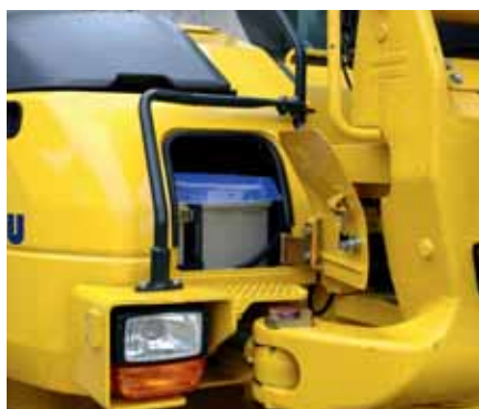
Přístup k akumulátoru z úrovně terénu
