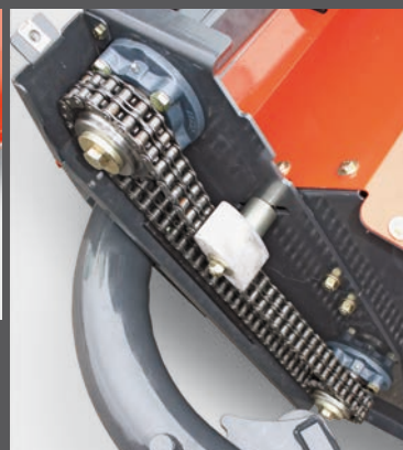
La velocidad del rotor del acondicionador, de 815 r.p.m., se puede cambiar a 650 r.p.m. modificando los piñones.
