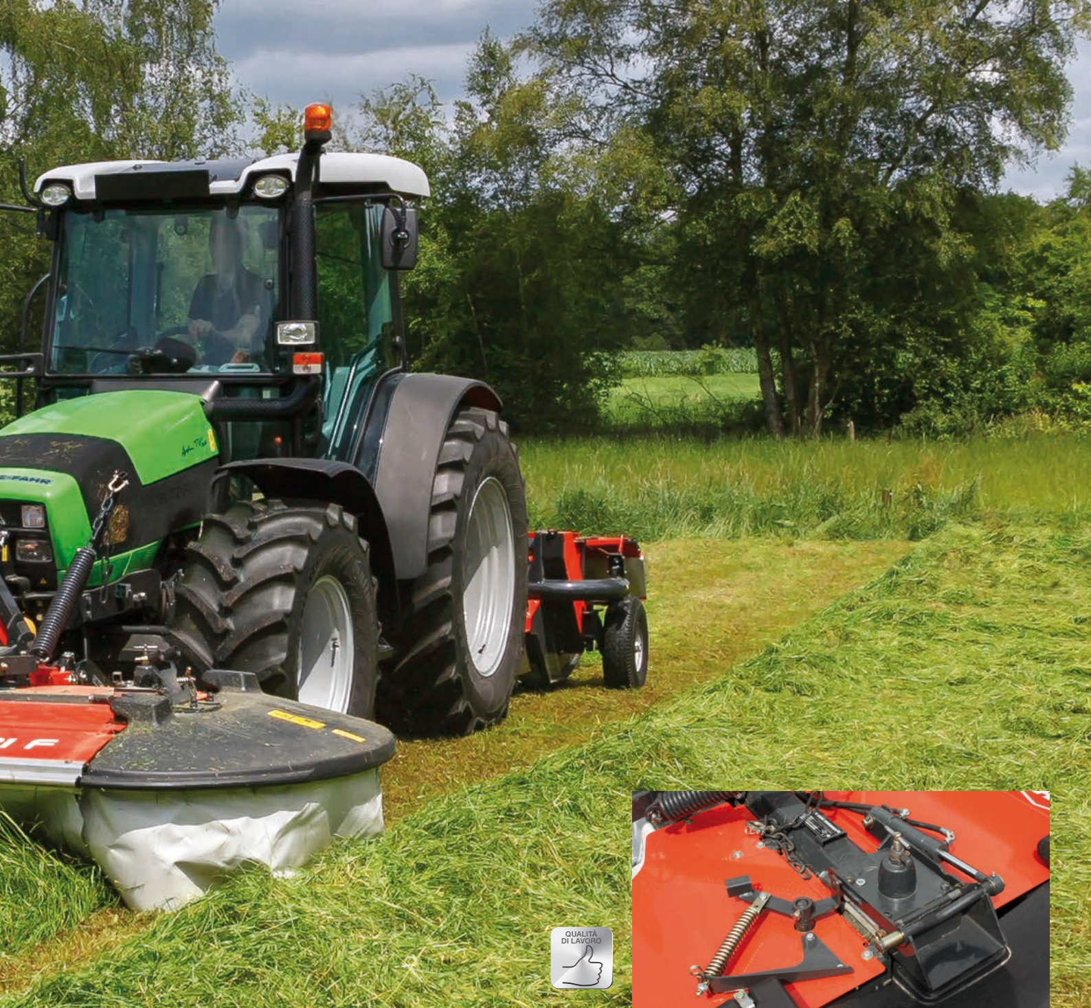
Dispositivo idraulico di ripiegamento dei cofani laterali
