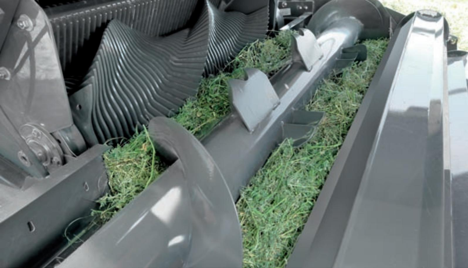
Mit ihrer breiten Pickup ist die QUADRANT selbst sehr breiten und unregelmäßigen Schwaden gewachsen. Schnell und rechensauber wird das Erntegut aufgenommen. Die Druckspeicher-Federung entlastet die Pickup absolut gleichmäßig, die großen, pendelnden Tasträder halten sie sicher in der Spur. Beides zusammen sorgt auch bei hohen Arbeitsgeschwindigkeiten und bei Kurvenfahrten für optimale Boden Anpassung und Schonung der Grasnarbe.
