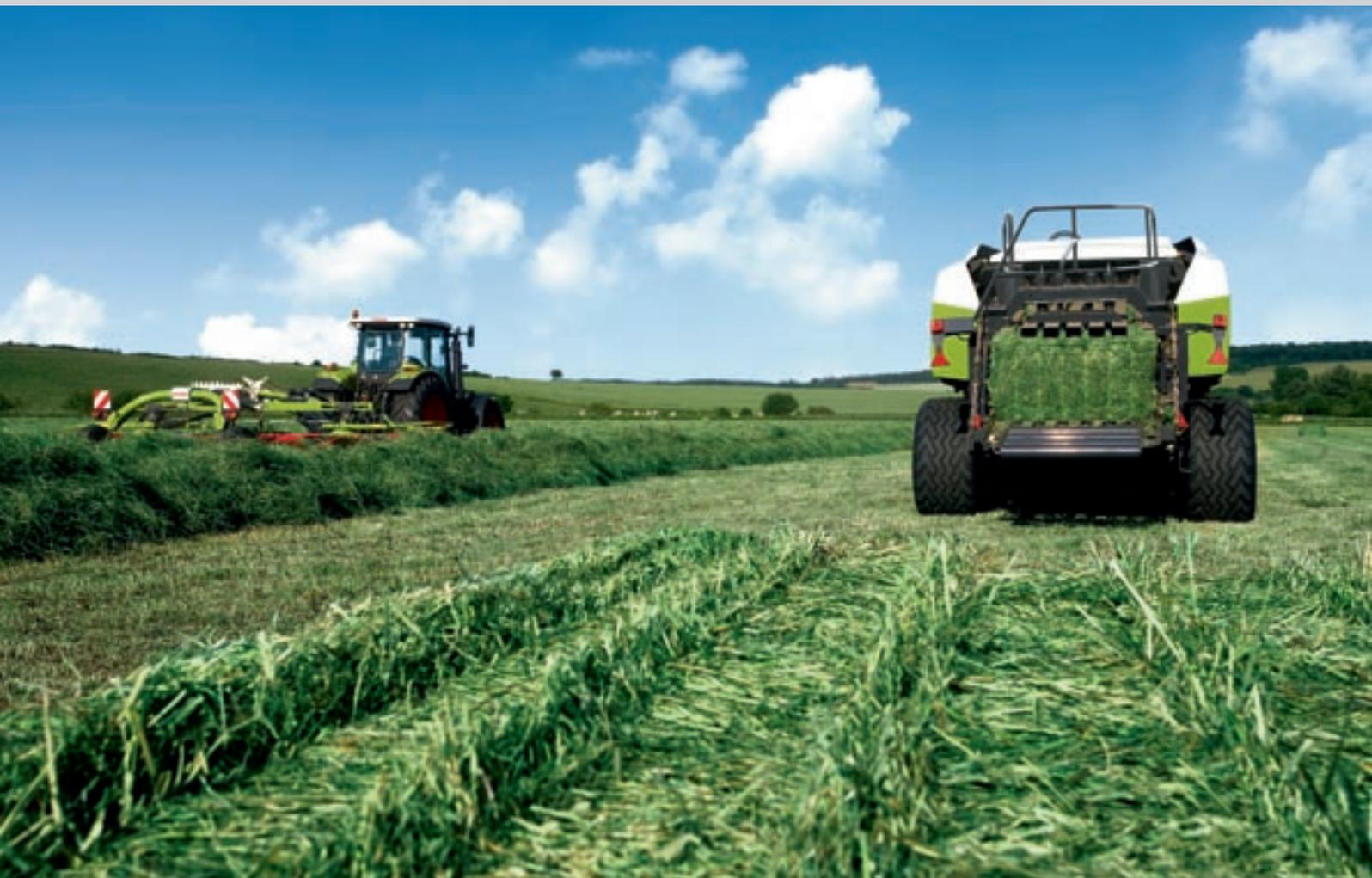
Zwei Optionen für mehr Fahrkomfort: Die Tandemachse (bis 40 km/h) und die Tandemlenkachse (bis 60 km/h) überzeugen durch hohe Laufruhe und geringen Bodendruck. Dank der bis zu 22,5 Zoll großen Bereifung wird das Gewicht auf einer großen Standfläche verteilt und der Boden optimal geschont.
