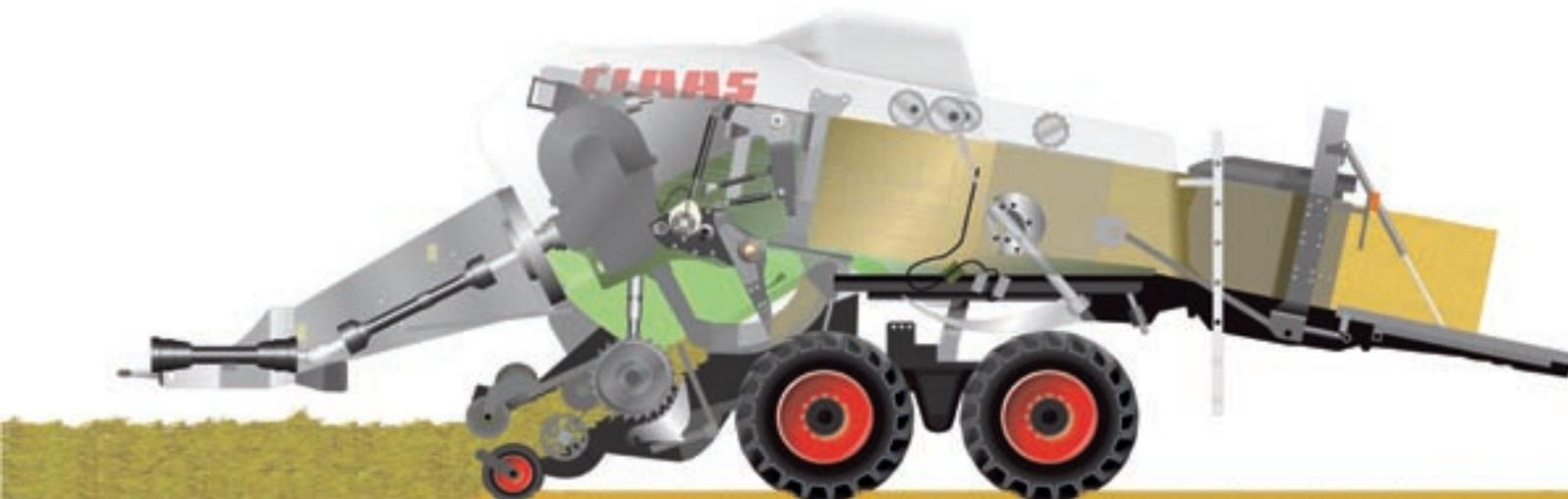
Die Vorkammer mit ihren einstellbaren Rückhalter sorgt ausgeschaltet bei großen Schwaden für maximalen Durchsatz. Bei kleinen Schwaden zugeschaltet für eine perfekte Ballenbelüftung.
