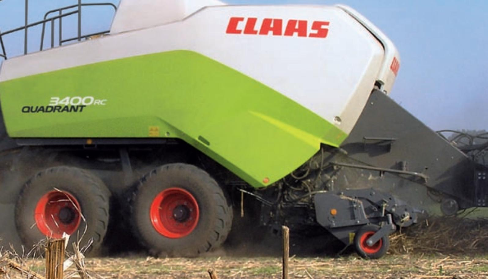
Der große Rotor nimmt strukturstarke Stängel ohne Probleme an, der groß dimensionierte Raffer hat eine sehr hohe Abwurfgeschwindigkeit und führt das Material extrem schnell und hoch dem Presskanal zu. Die Schneidarbeit zwischen Kolben und Presskanalboden wird so auf ein Minimum reduziert. Dies spart Kraft und damit Kraftstoff.
