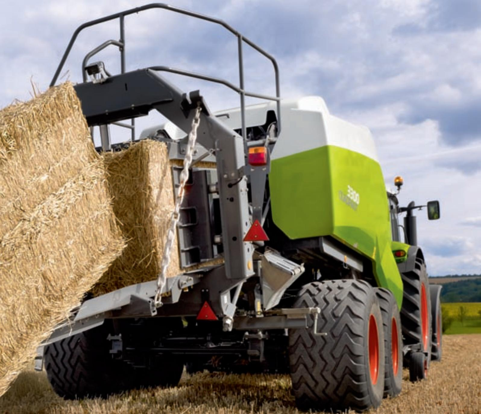
Mit der neuen QUADRANT 3300 mit 120 x 90 cm Ballenmaß erweitert CLAAS sein Produkt um eine Maschine, die mit ausgereifter Rotortechnik und ohne Schneidwerk in allen Futterarten äußerst schonend arbeitet. Durch den neuartigen Presskanal pressen Sie gleichmäßig feste und darüber hinaus sicher gebundene Ballen.
