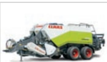
Der Krassort SPECIAL CUT Strohhäcksler ist optimal in das Gutflusskonzept der QUADRANT 2200 RC ADVANTAGE integriert. 180 Messer häckseln das Erntegut mit ziehendem Schnitt besonders kurz und trotzdem kraftsparend.
