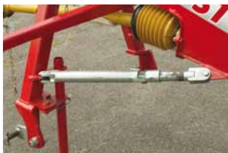
Kuličková ložiska na obou koncích ramen
