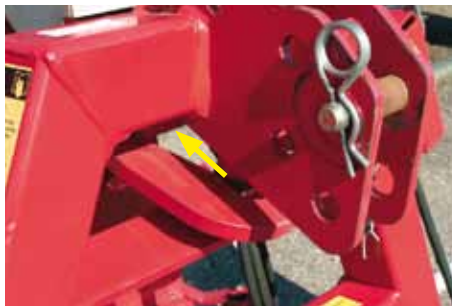
Tříbodový závěs s kloubovým spojením je standardem.
