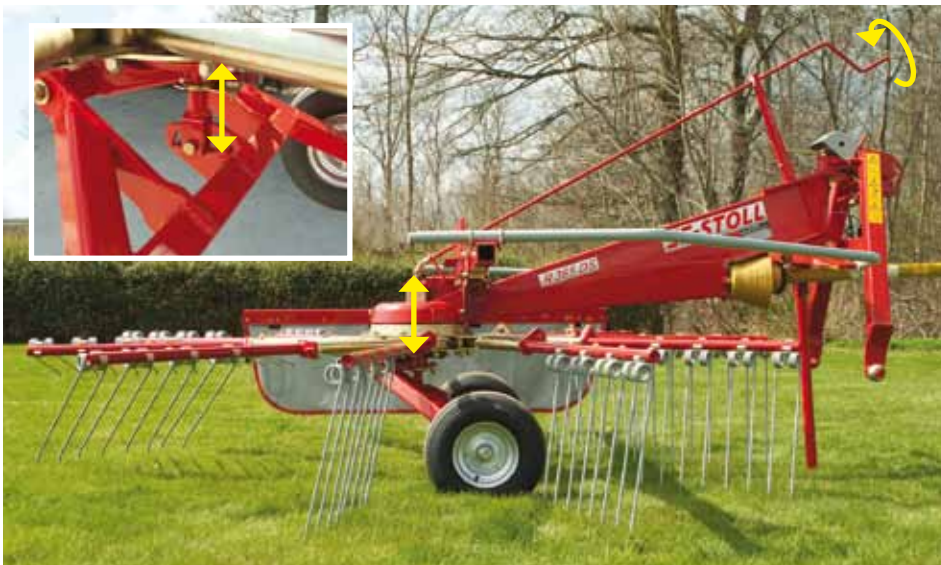
Tříbodový závěs s kloubovým spojením je standardem.
