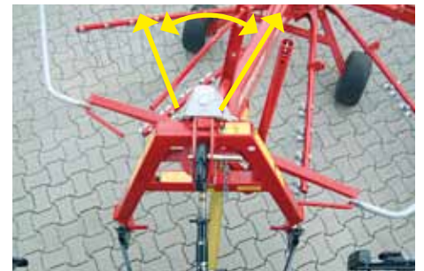
Díky tříbodovému závěsu s kloubovým spojením shrnovač vždy bezpečně sleduje stopu traktoru.
