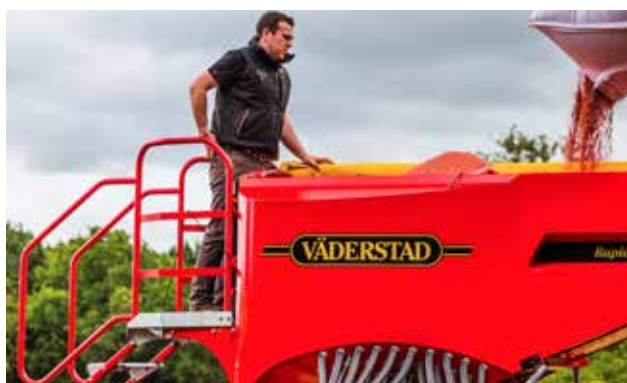
Rapid A 400–800S оснащен центральной платформой с доступом с обеих сторон.
