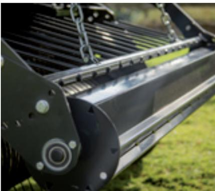
El rodillo retenedor reparte el material en toda la anchura del recogedor y facilita un flujo uniforme del mismo, reduciendo el riesgo de bloqueos e incrementando el rendimiento de la máquina.
