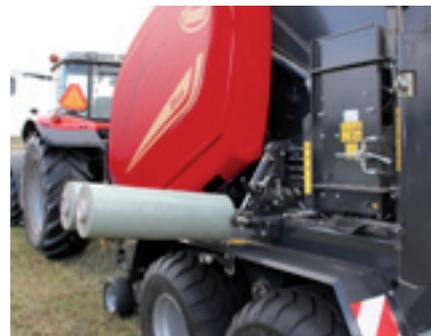
Los soportes de bobinas de repuesto descenden hidráulicamente.
