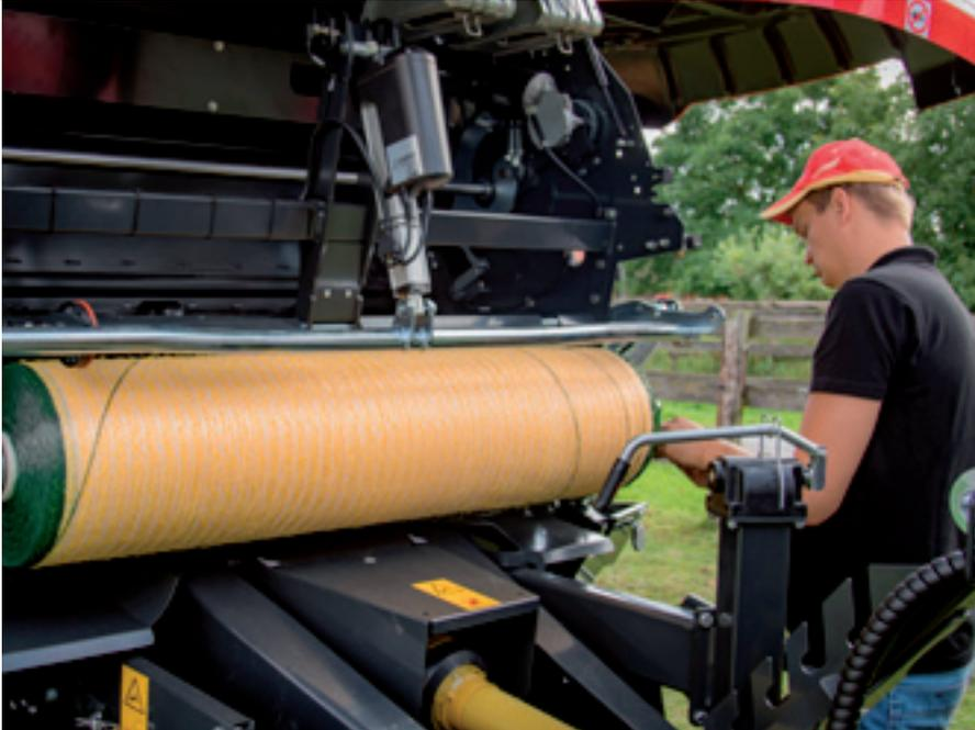
La baja altura de carga facilita el reemplazo de las bobinas de malla.
