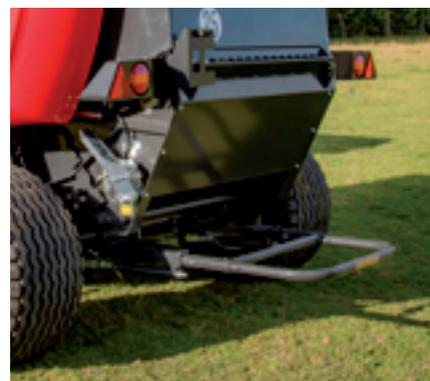
Rampa de descarga que facilita la salida de la paca y evita tener que maniobrar tras expulsarla.
