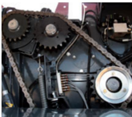
Una cadena de 1 ¼" de larga vida útil y mínimo mantenimiento es la encargada de transmitir el esfuerzo a los principales accionamientos de la rotoempacadora.
