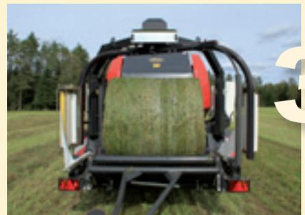
Tras la descarga, la compuerta desciende para poder seguir empacando.
