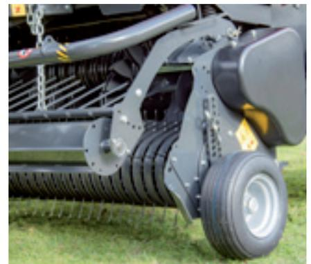
Las ruedas con neumáticos de flotación son de fácil ajuste para un buen seguimiento del terreno. El exclusivo diseño del recogedor permite no tener que desmontarlas en los desplazamientos por carretera.
