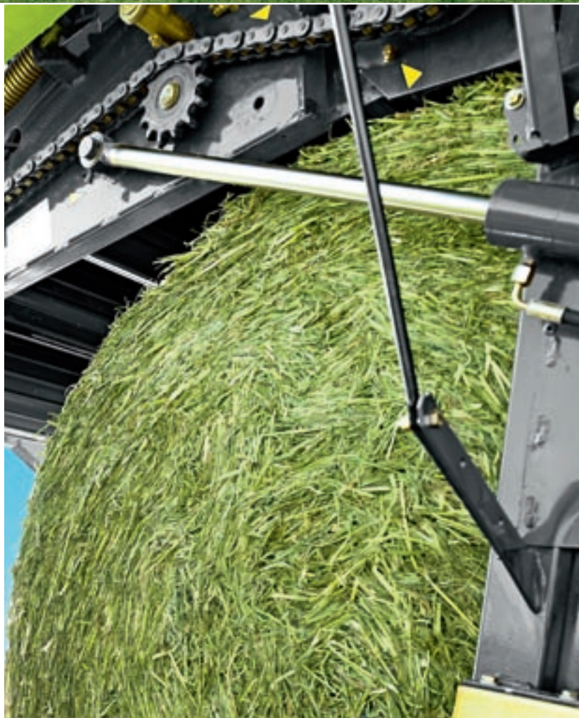
Cámara de empacado
