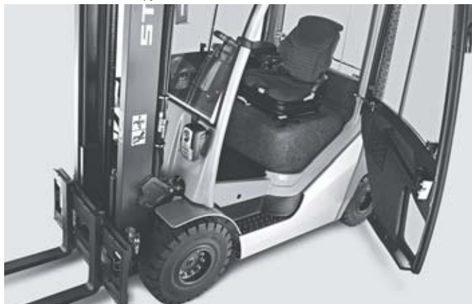
Большое пространство для ног, удобный вход в кабину погрузчика, гарантирующий легкость посадки и высадки
