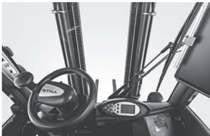
Оптимальный обзор впереди благодаря узкой конструкции мачты и низкому расположению приборной панели
