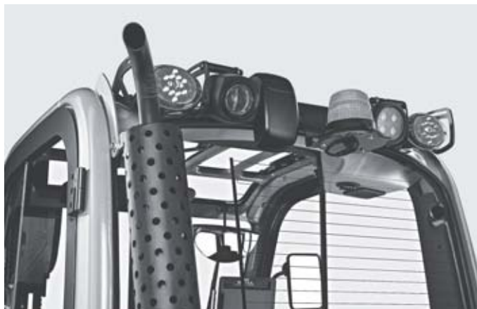
Сигнальное устройство Safety Light 4Plus и светодиодные фонари способствуют повышению безопасности
