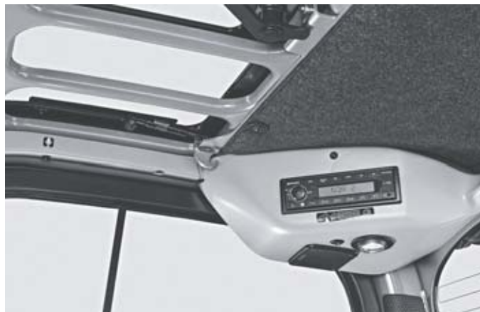
Коммуникационный интерфейс: радио с USB и устройство громкой связи Bluetooth
