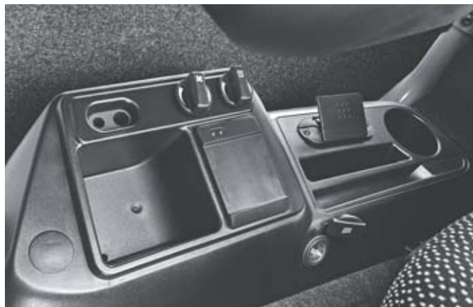
Отделения для хранения и розетка на 12 В, напр., для подзарядки мобильного телефона
