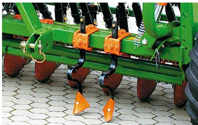
Las sembradoras suspendidas en funcionamiento autónomo pueden llevar borrahuellas incorporados que eliminan la huella del tractor desde el exterior. Para suelos muy pedregosos hay borrahuellas dotados de suspensión especial.
