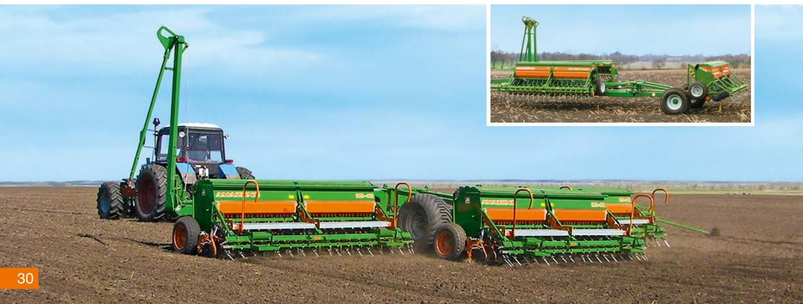
se coloca en posición vertical. La sembradora media está equipada con un sistema de calles (control de «tramlines») que permite crear calles separadas 12 m, 24 m ó 36 m. Para el transporte se pliegan las máquinas laterales. En estado plegado, la anchura de transporte es de aprox. 6 m. En total sólo se precisan dos válvulas de control hidráulicas en el tractor. Las tres D9 Super pueden utilizarse también individualmente.
