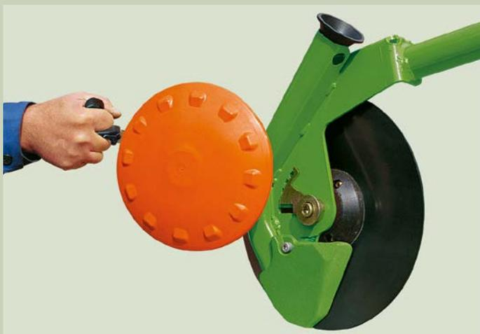
Para profundidades de deposición muy grandes, el disco de guiado en profundidad se retira por completo con una sola operación.
