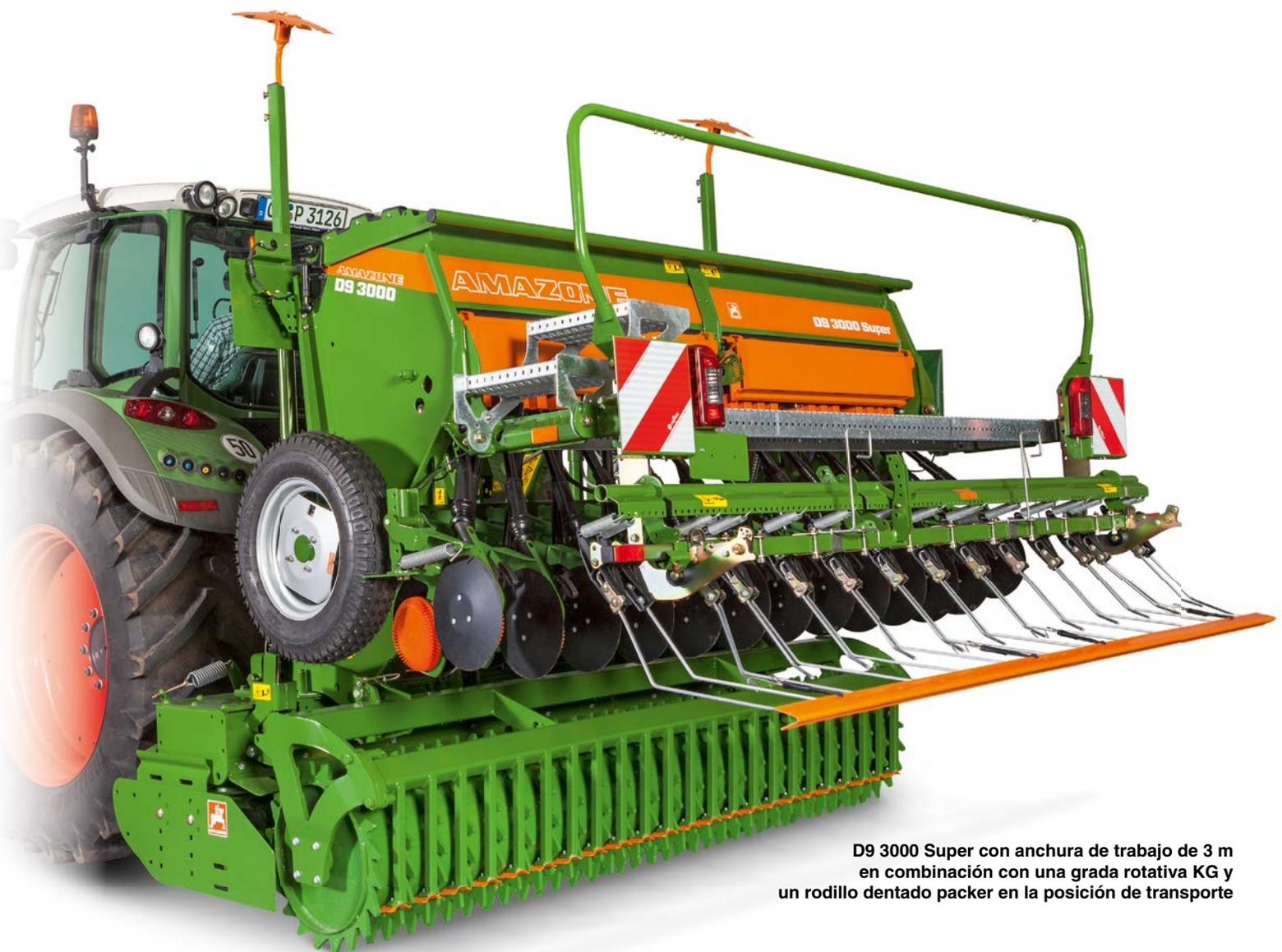
D9 3000 Super con anchura de trabajo de 3 m en combinación con una grada rotativa KG y un rodillo dentado packer en la posición de transporte
