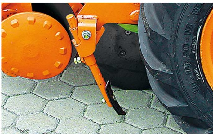
Las rodadas de las ruedas se pueden eliminar adicionalmente mediante un borrahuellas con mecanismo de seguridad contra piedras delante de la reja exterior.
