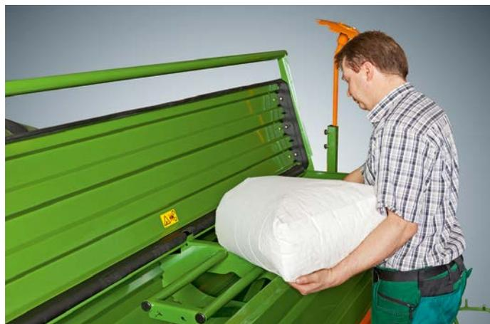
El sistema auxiliar para la carga simplifica el llenado del depósito de semillas con sacos.
