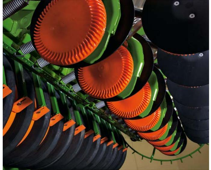
Los discos RoTeC-Control avanzan ejerciendo hasta 35 kg de presión. En este caso, la presión efectiva real de la reja de las máquinas AMAZONE es comparativamente mayor, porque la presión no se distribuye entre la reja y el rodillo de presión subsiguiente, sino que se transmite exclusivamente a la reja. Cuando se siembra colza o para siembras tempranas en condiciones secas, se puede sembrar sin problemas incluso con una menor presión de la reja.
