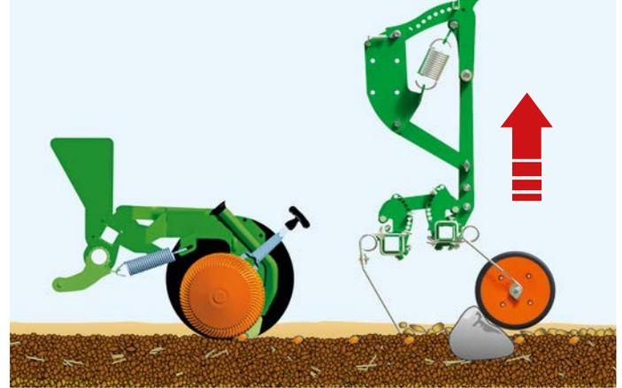
Cuando golpea una piedra, el disco RoTeC-Control solo se eleva una vez. En las otras rejas con suspensión de paralelogramo con rodillo fijado a la reja, esta acción se produce dos veces.
