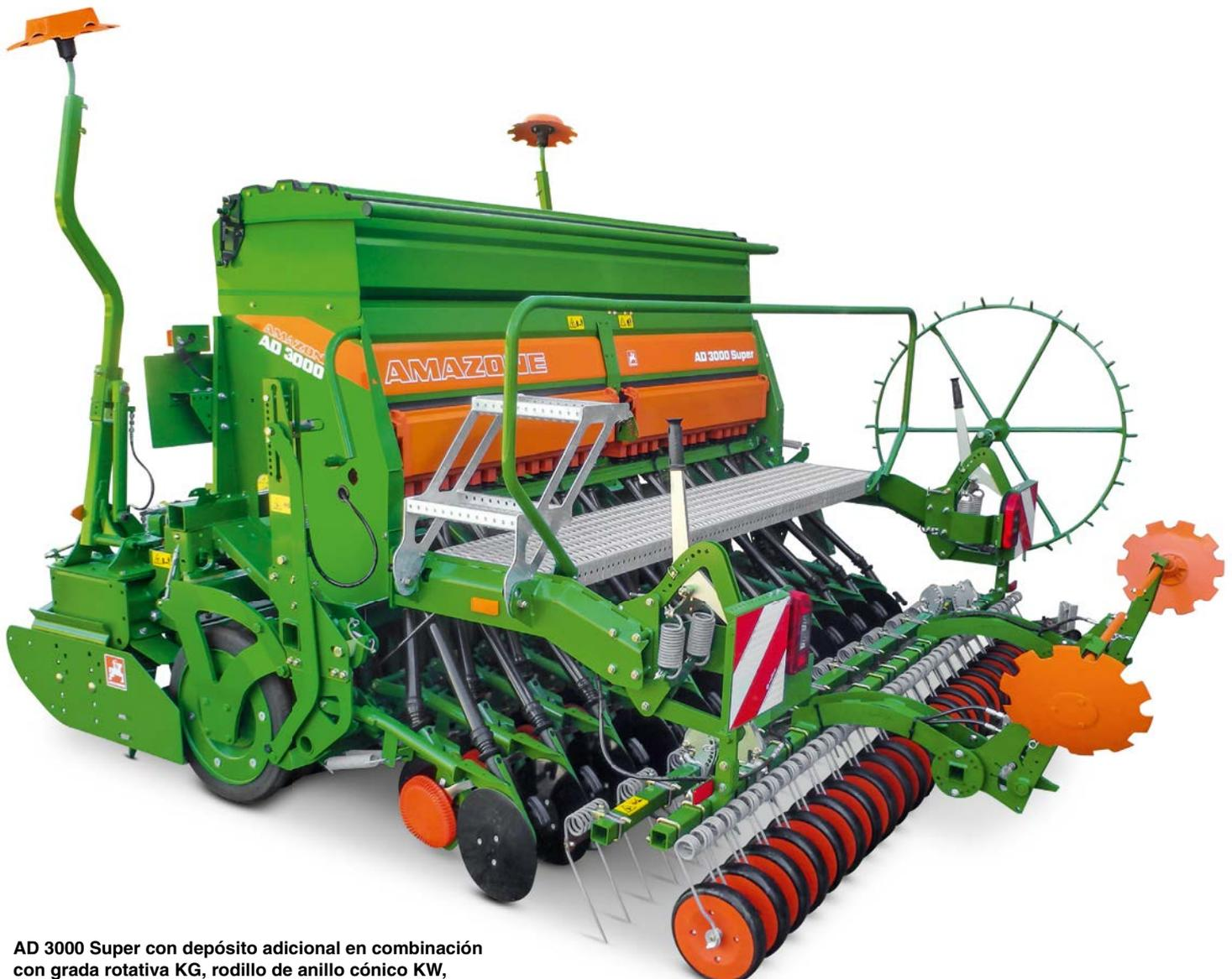
AD 3000 Super con depósito adicional en combinación con grada rotativa KG, rodillo de anillo cónico KW, discos RoTeC-Control y rastra de rodillos.
