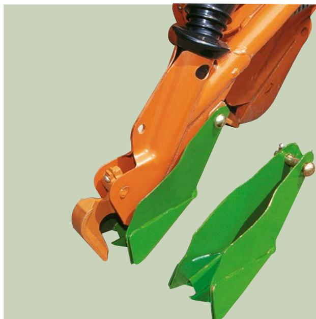
**Las botas** para siembra en franjas se pueden colocar fácilmente para distribuir las semillas en franjas y para reducir la profundidad de deposición de las mismas.
