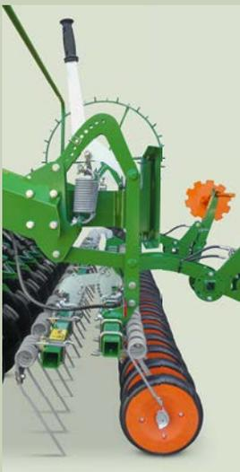
La rastra de precisión se ajusta de forma continua mediante husillos. El ajuste centralizado de la rastra de rodillos se realiza mediante un dispositivo de ajuste con protección contra sobrecargas. De este modo, en la rastra de rodillos también se puede ajustar de forma muy flexible la presión del rodillo o incluso hacer que los rodillos de presión no ejerzan fuerza. Los rodillos de presión pueden
