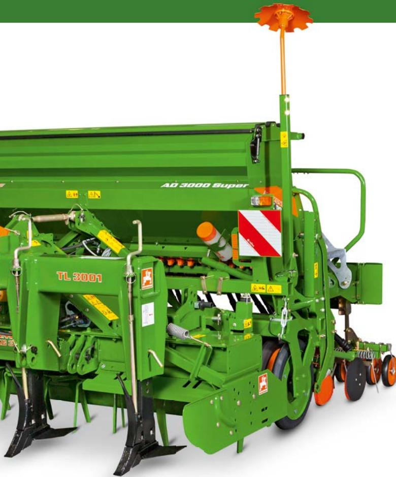
Sembradora suspendida AD en combinación con un descompactador TL, un cultivador rotatorio KG y rodillo de anillo cónico KW
