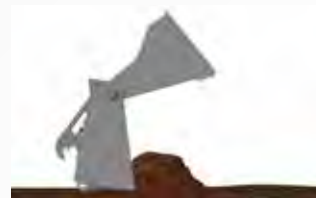
II. Planierarbeiten mit geöffnetem Schaufelkörper
