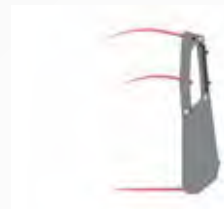
Verschleißschiene am dickwandigen Zinkentragrohr
