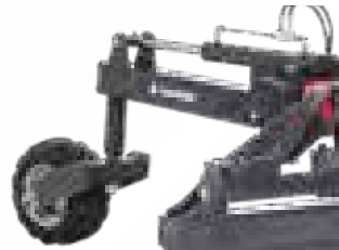
Luftbereiftes, spindelverstellbares Zentralstützrad 360° drehbar (optional hydraulisch) für eine optimale Höhenführung
