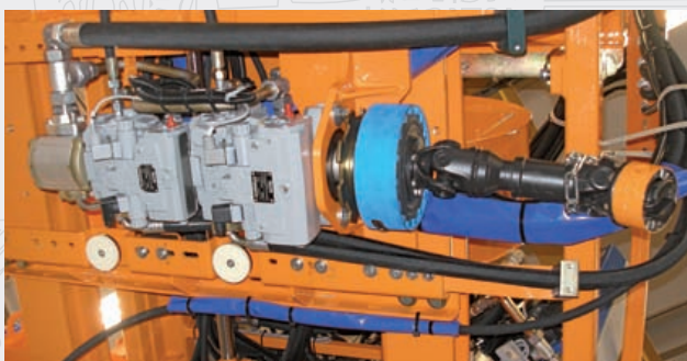
Pumpenantriebsstrang mit Schnelllösekupplung
