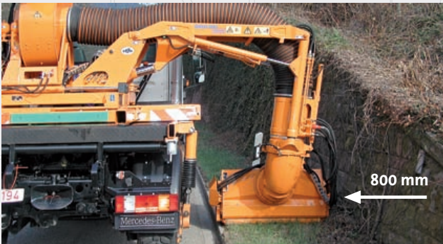
Querverschub – im Arbeitseinsatz zeigen sich die Vorteile
