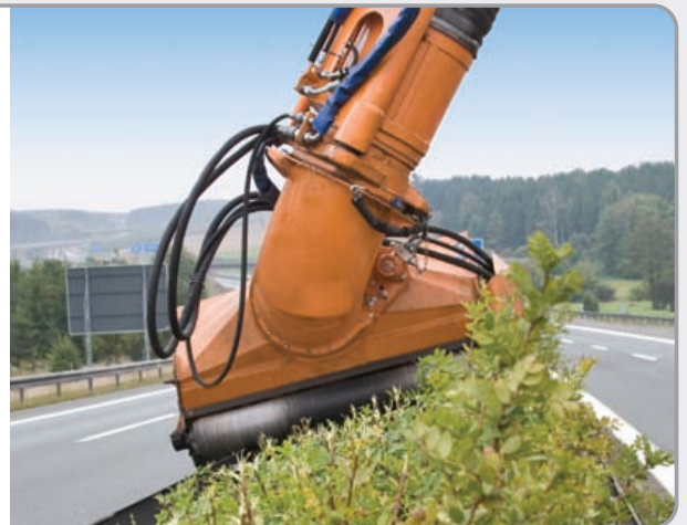
Funktionsweise des HSK 1200 Heckenschneidkopfes
