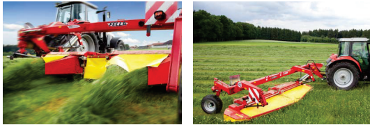
Randmähen (Schrägstellung Mähwerk 25°)
