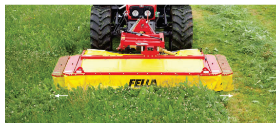
SM 260 FP-S: hydraulisch stufenlos seitlich verschiebbar (je ca. 20 cm)
