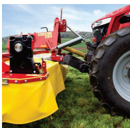
SM 310 FP-K extrem kompakter Anbau am Traktor
