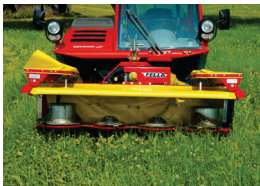
Vier Mähscheiben für symmetrisch mittigen Lauf
