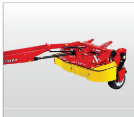
Große Bodenfreiheit durch hohe Aushubhöhe am Vorgewende (bis 600 mm)
