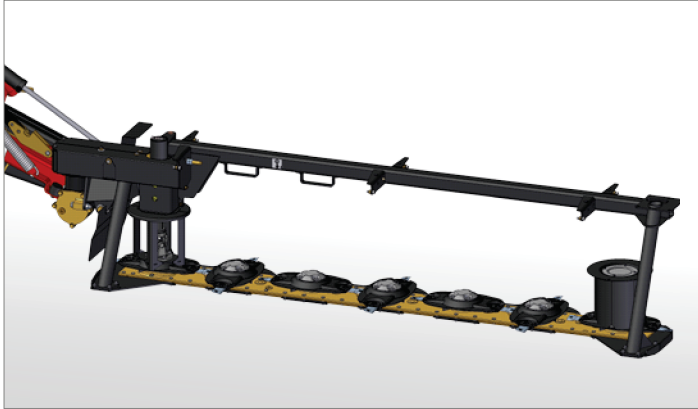
Tragrahmen/Abstützung von außen
