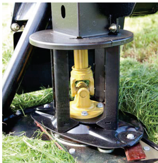
Antrieb von oben direkt in die erste Mähscheibe
