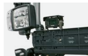
Eine hoch auflösende Kamera vorne rechts liefert auch bei Restlicht scharfe Bilder.
