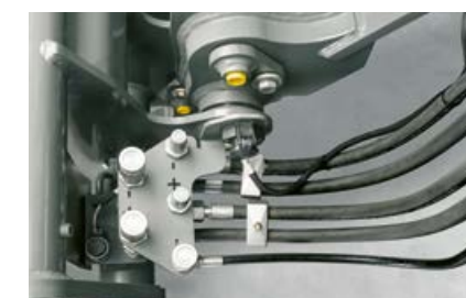
Hydraulikanschlüsse sicher untergebracht am Geräteträger.
