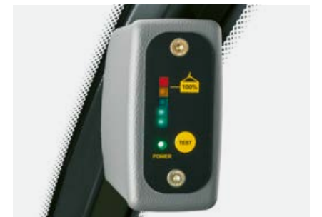
Lastanzeige mit eindeutiger Ampelsymbolik: Ist die Stabilitätsgrenze überschritten, leuchten alle Dioden auf und es ertönt ein Alarmton.
