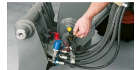
Steckdosen zur flexiblen Stromversorgung verschiedener Anbau- und Anhängegeräte
