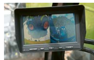
Die Bilder der Front- und Heckkameras werden auf den Monitor in der Kabine übertragen.
