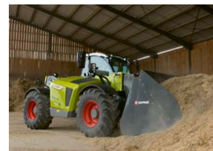
Automatische Schaufelrückführung für schnelleres Arbeiten in Bodennähe.
