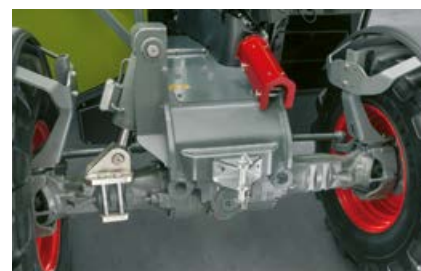
Mehr Sicherheit im Gelände durch hydraulischen Niveau-Ausgleich
