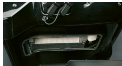
Guter Zugang zum Frischluftfilter für die Kabine.
