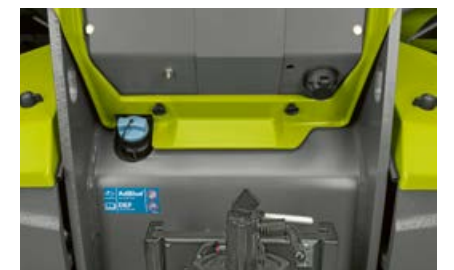
Gut zugänglicher AdBlue-Einfüllstutzen zur effizienten Abgasnachbehandlung.
