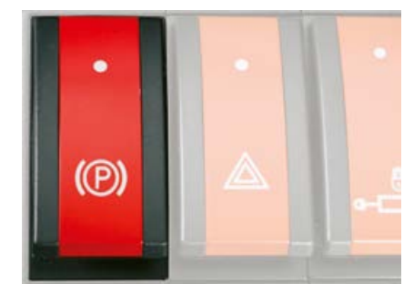
Mit dem Kippschalter kann die Feststellbremse manuell aktiviert werden.
