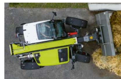
Mehr Präzision durch manuellen Hundegang
