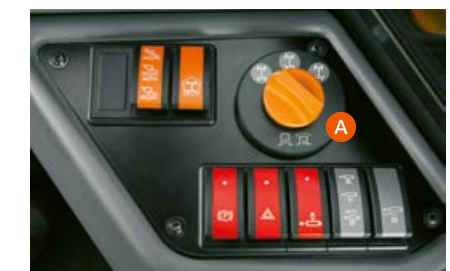
Dreh-Drückschalter (A) zur Auswahl der Lenkart im SCORPION VARIPOWER.
