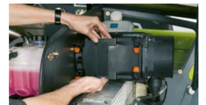
Воздушный фильтр двигателя легко доступен и не требует инструмента для технического обслуживания.
