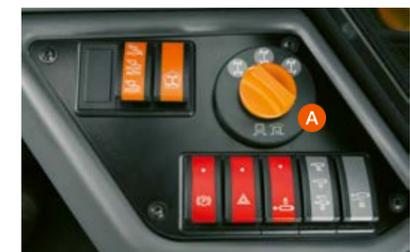
Поворотно-нажимной переключатель (A) для выбора типа рулевого управления в моделях SCORPION VARIPOWER.
