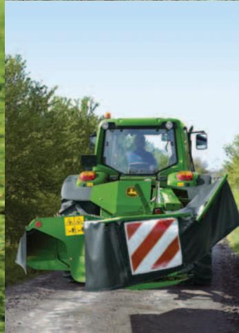
Las segadoras acondicionadoras se pliegan hacia atrás y se bloquean para ofrecer una anchura de transporte inferior a 2,5 m.
