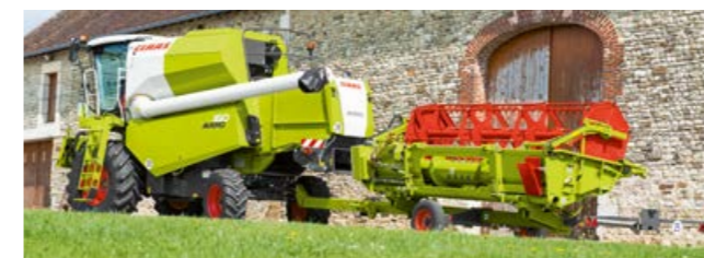
Schnelles und einfaches Umsetzen, auch zwischen weit entfernten Flächen, ist mit dem Transportwagen problemlos möglich.
