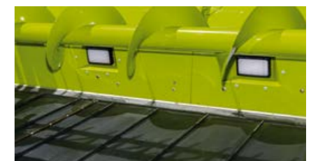
Starke Arbeitsscheinwerfer leuchten Schneidwerk und Trog perfekt aus.
