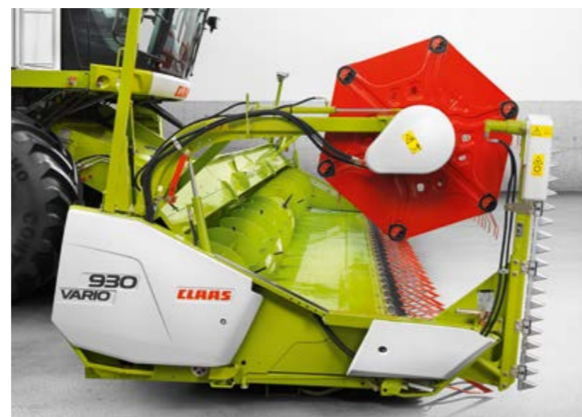
Schneidwerkstisch ausgefahren – mit Rapsmesser (+ 600 mm).
