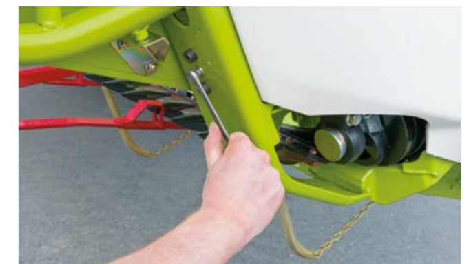
Einfache Höhenverstellung des Halmtellers mit dem Klappenschlüssel.
