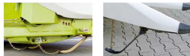
Tastbügel erfassen die Position des Vorsatzgerätes für AUTO CONTOUR und CONTOUR.
