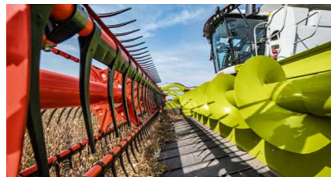
Molinete dirigido por excéntrica con concepto Flip-Over
