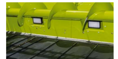
Potentes focos de trabajo iluminan de forma perfecta el mecanismo de corte y la cuba.
