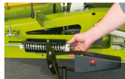
La marcha en línea recta y el correcto tensado de las cintas aseguran la vida útil de las mismas.
