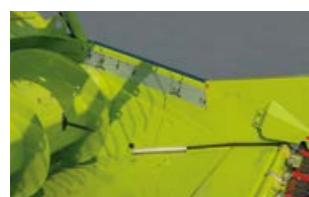
L'indicatore di posizione della tavola della piattaforma di taglio è perfettamente visibile dalla cabina.
