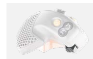
Con la leva multifunzione CMOTION si regolano la tavola della piattaforma di taglio VARIO, la lama di taglio MAXFLEX e la velocità dei nastri trasportatori CONVIO.
