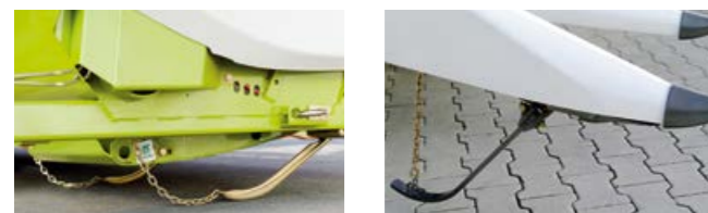
Archi tastatori rilevano la posizione della testata per l'AUTO CONTOUR e il CONTOUR.
