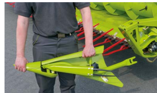
Sostituzione rapida e semplice degli sparticampo.
