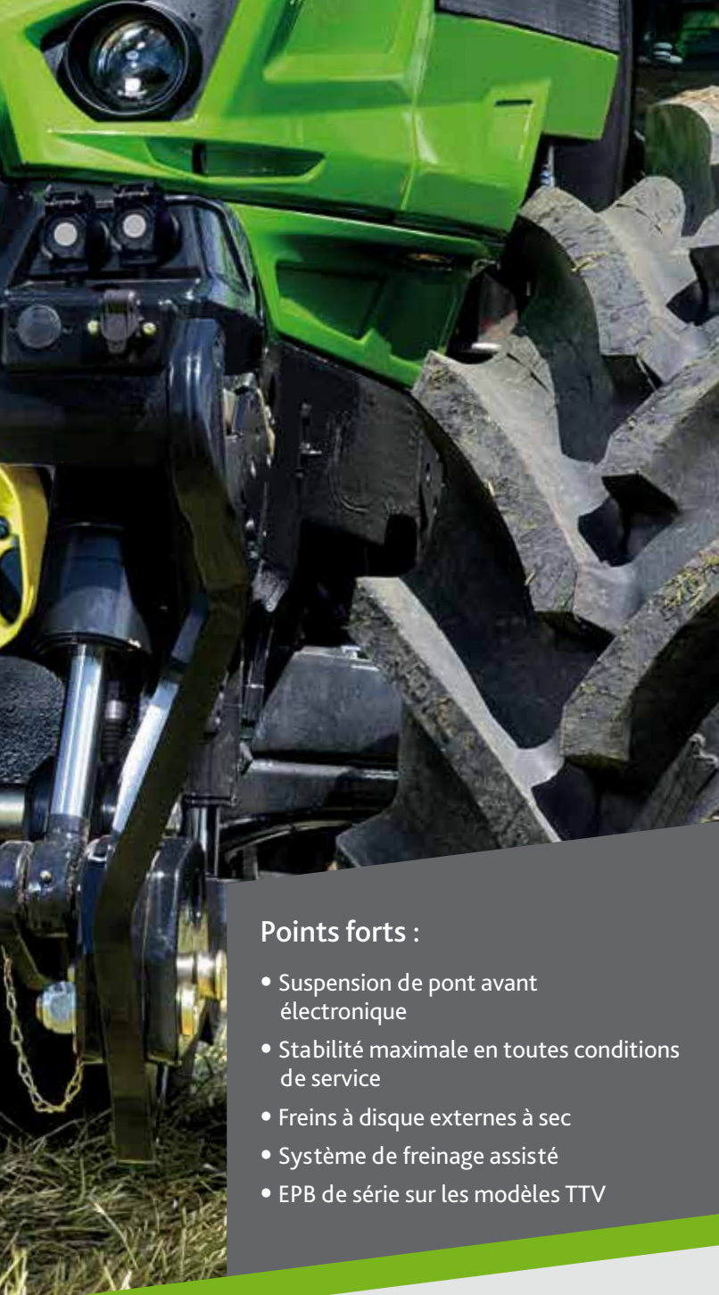
Suspension électronique intégrant un système « anti-plongée » et « anti-cabrage ». La suspension peut servir tant dans les champs que sur route. Entièrement verrouillable au besoin.
