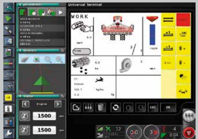
Fonctions de prédisposition TIM (Tractor Implement Management) pour répondre automatiquement aux exigences de l'outil.
