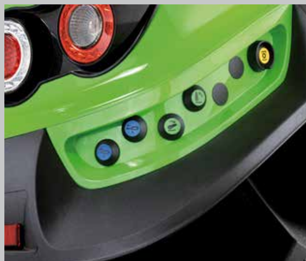
Relevage hydraulique extérieur arrière et arbre de PDF sont facilement commandés de chaque côté.
