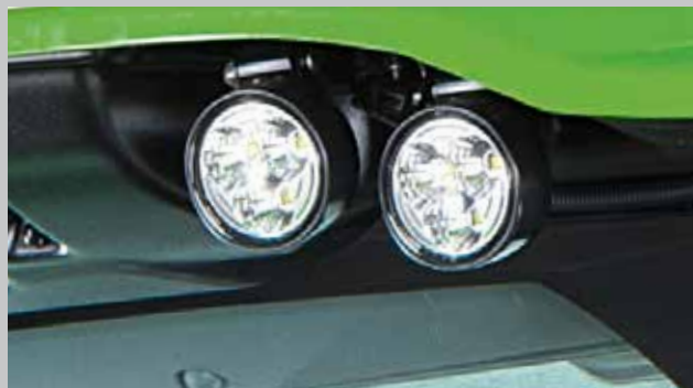
Jusqu'à 16 phares de travail à LED (IV génération, 2 500 lumen par phare).
