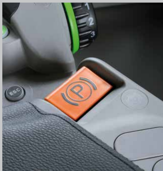
Modèles TTV – L'EPB remplace le levier de frein à main mécanique et est actionné par le biais d'une commande électrique à bouton-poussoir sur la console de l'accoudeur.
