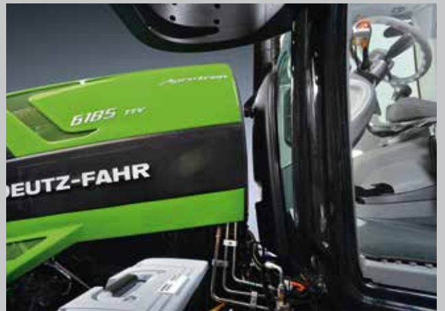
La cabine et le capot sont séparés l'un de l'autre pour réduire de manière significative le bruit et les vibrations et par conséquent assurer le confort maximum.
