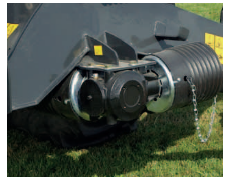
Caja principal de engranajes para dos velocidades de toma de fuerza, 540 y 1.000 r.p.m.
