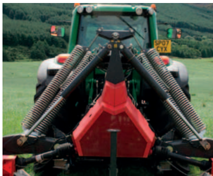
Robustos muelles de compensación de presión.
