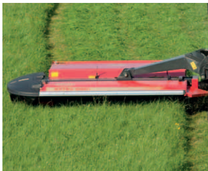
Acoplamiento central para un reparto homogéneo de los pesos.
