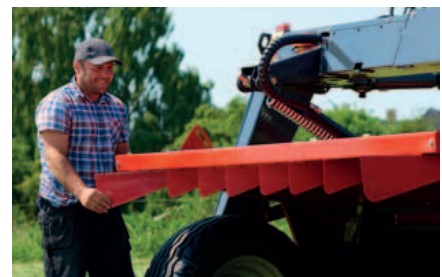
Se desmontan las planchas hileradoras y ya está lista para segar.
