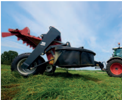
500 mm de luz libre para facilitar las maniobras en campo y transporte.
