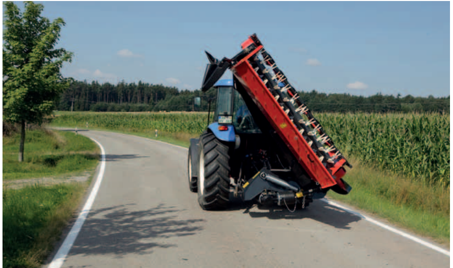
Perfecto reparto del peso en transporte con el plegado vertical a 125°.
