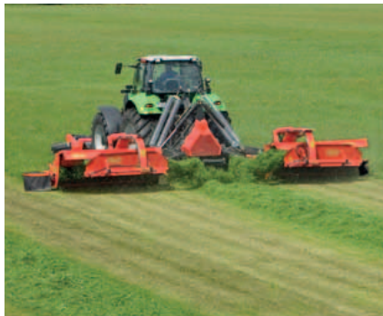
Con las cintas BX Vicon, el forraje de 6,00 o 9,00 m se deposita en una sola hilera.
