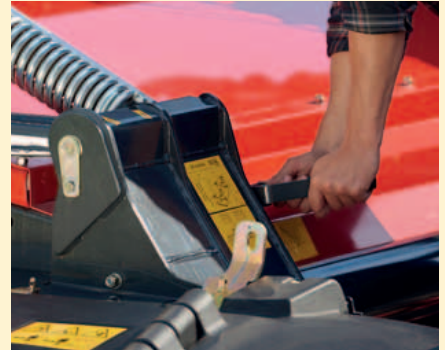
Fácil ajuste del paladar acondicionador.
