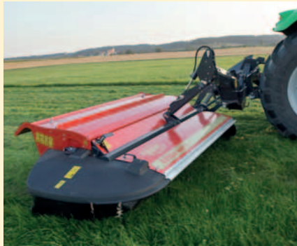
Ingenioso bastidor, con la unidad de corte completamente suspendida.
