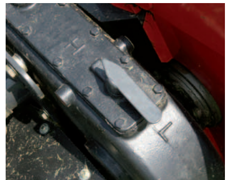
Leva para variar la velocidad del acondicionador.
