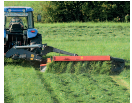
Rápido paso de hilerado a esparcido.
