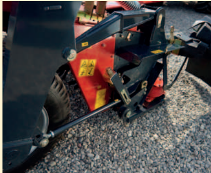
Ante un obstáculo la unidad de corte se eleva para sobrepasarlo.
