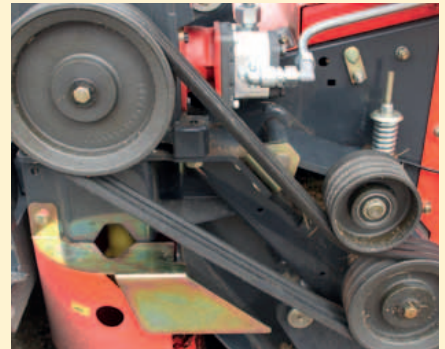
Ajuste de la velocidad del rotor acondicionador.
