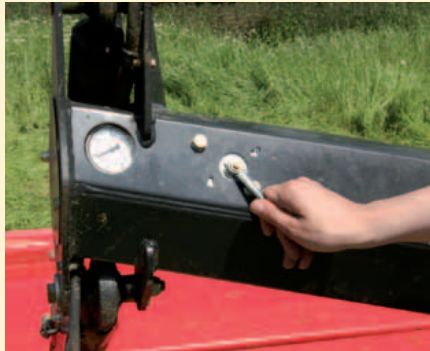
Ajuste hidráulico para mantener siempre la presión deseada sobre el terreno.
