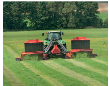
Si no se utilizan las cintas hileradoras se elevan hidráulicamente por encima de las unidades de corte. Desde el panel ISOBUS se elige la configuración deseada.
