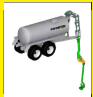
Vorderer Ansaugrüssel mit eingetauchtem Turbofüller
