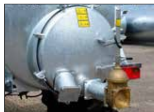
Mannloch auf Scharnieren Ø 850 mm (auf MODULO2 ohne Verstärkung)
