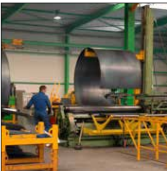
Biegen des Bleches (digital gesteuerte Biegepresse)
