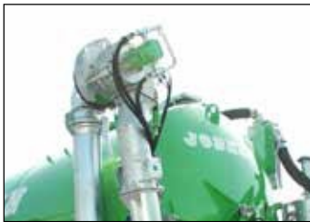
Turbofüller auf gelenkigem seitlichem Ansaugarm
