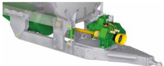
Mechanischer Antrieb über das Getriebe der 2 Pumpen
