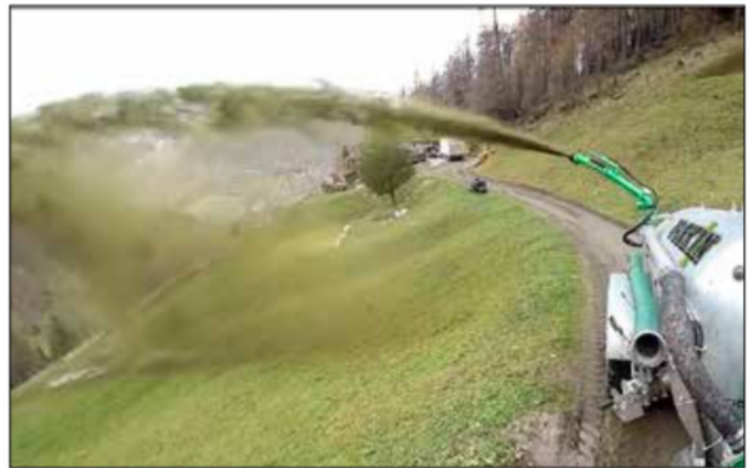
Senkrechte Ausrichtung der Weitwurfdüse durch Hydraulikzylinder (optional).
