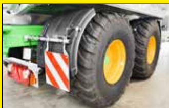
Kotflügel auf Vacu-CARGO mit unabhängigen Spritzlappen
