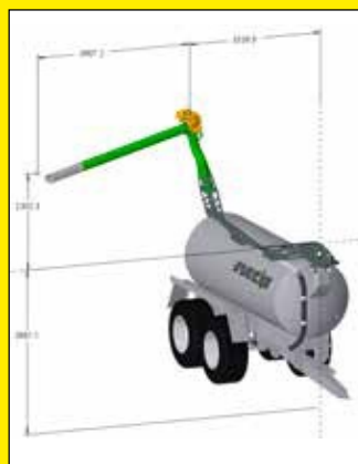
Flecha dorsal en posición desplegada montada sobre punto de giro en la parte delantera (los valores varían según la configuración elegida)
