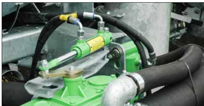
Inversor de bomba hidráulica
