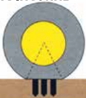
Superficie de contacto sobre el suelo reducida
