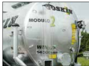
Indicador de nivel comunicante transparente Ø 150 mm
