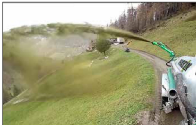
Orientación vertical del cañón de esparcimiento por cilindro hidráulico (opcional)
