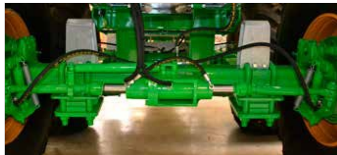
Eje seguidor (50 % direccional)
