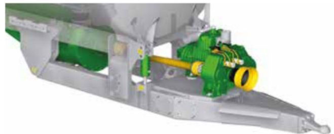
Accionamiento mecánico vía caja de las 2 bombas
