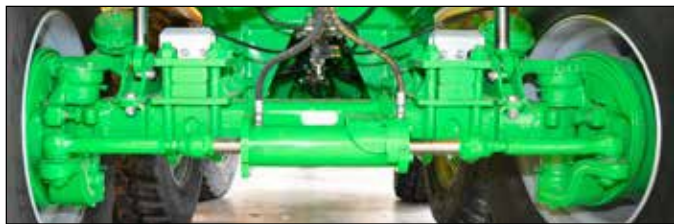
Eje direccional forzado (100 % direccional)
