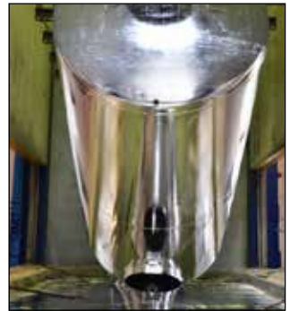
Galvanización en caliente (interior y exterior)
