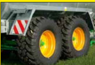
Guardabarros sobre eje doble SIN encastramiento de las ruedas
