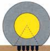
Superficie de contacto mayor: el neumático se desarrolla como una oruga
