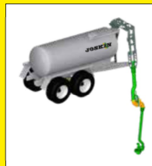
Flecha delantera con turbo sumergido
