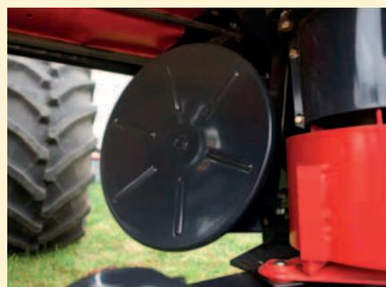
La macchina è provvista standard di due dischi andanatori, in grado di formare un'andana da 2.20 a 2.40 m.
