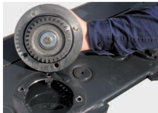
Ogni supporto e ingranaggio può essere rimosso velocemente, per una grande semplicità di manutenzione.
