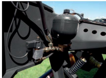
Sospensioni idrauliche per una regolazione della pressione al suolo molto precisa (modello EXTR $\Delta$  440H).
