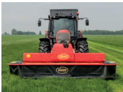
Disponibili standard due velocità di trasmissione: standard a 1000 giri/min, ma è possibile azionare la puleggia in modo da ottenere una velocità di 750 giri/min, riducendo il consumo di carburante.
