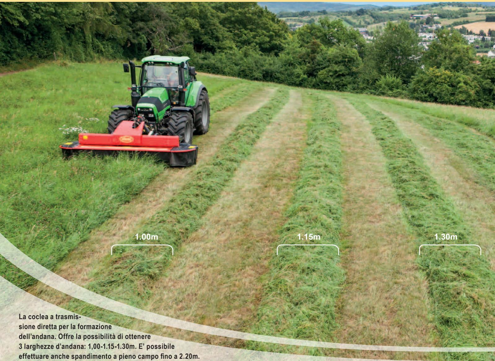
La coclea a trasmissione diretta per la formazione dell'andana. Offre la possibilità di ottenere 3 larghezze d'andana: 1,00-1.15-1.30m. E' possibile effettuare anche spandimento a pieno campo fino a 2.20m.
