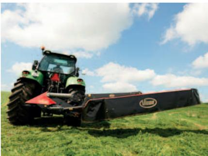
Semplice sollevamento a fine campo tramite cilindro idraulico, con ampia luce da terra.
