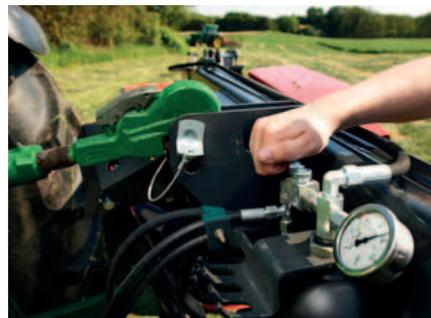
Regolazione idraulica della pressione (modelli EXTR $\Delta$  428H e 432H).
