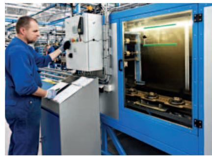
Tutte le barre di taglio vengono testate termicamente e controllate per i livelli di rumorosità.
