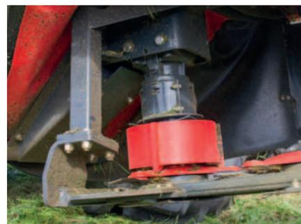
Trasmissione diretta dalla scatola di trasmissione al primo disco.
