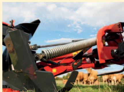
Sistema di protezione della barra di taglio Vicon NonStop BreakBack.
