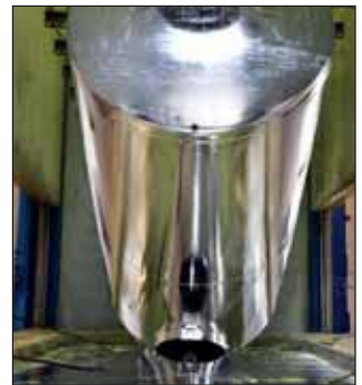
Bain de galvanisation à chaud (intérieur et extérieur)
