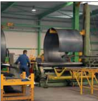
Cintrage de la tôle (cintreuse à commande numérique)
