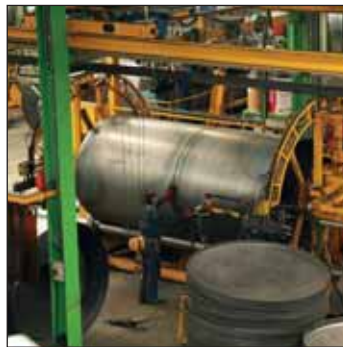
Assemblage des viroles et des fonds
