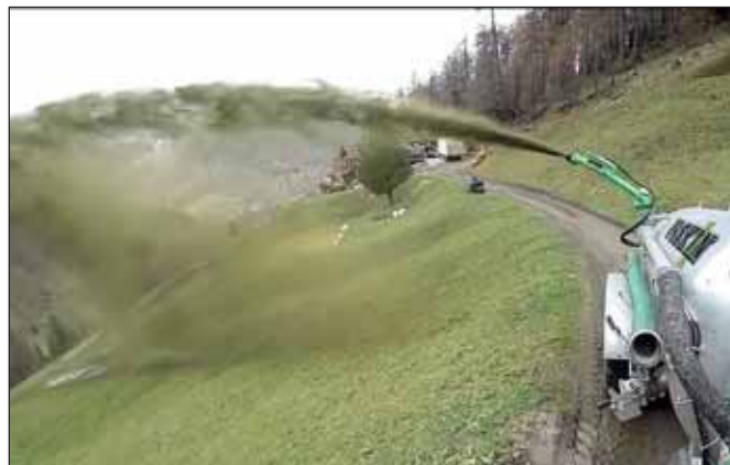
Orientation verticale du canon d'épandage par vérin hydraulique (en option).
