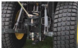
**Enganche trasero ajustable en altura:** Ajuste de altura sencillo en remolques con enganche de rótula y horquilla.
