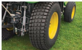
**Turf:** Para segar, escoja neumáticos de turf con un dibujo menos agresivo.
