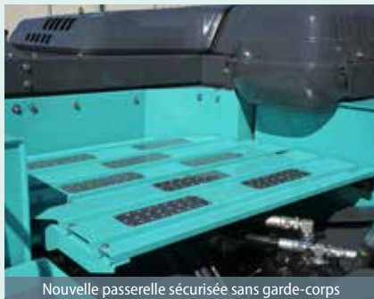
Nouvelle passerelle sécurisée sans garde-corps
