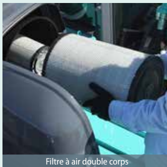
Filtre à air double corps
