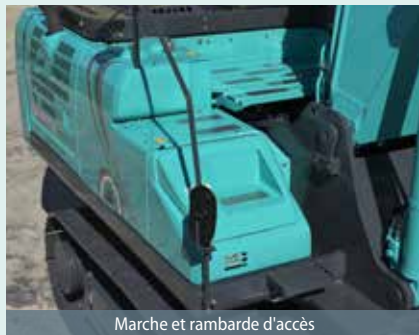
Marche et rambarde d'accès
