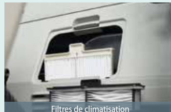
Filtres de climatisation
